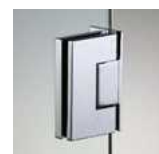
Cerniere in ottone con finitura lucida, con angolo di rotazione -90° / +90° con scatto a 0° e fermo a -90° e +90°: per ogni anta ne vengono montate due.
