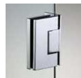
Cerniere in ottone finitura lucida, con angolo di rotazione -90° / +90° con scatto a 0° e fermo a -90° e +90°: per ogni anta ne vengono montate due.
